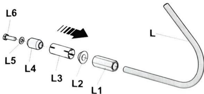
**D** Schrauben Sie die Mutter **L1** auf der Gewindestange **L** bis sie zu stoppen.
