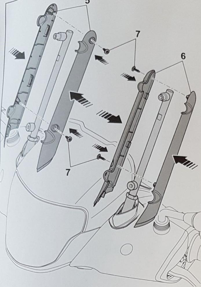
**D** Die Abdeckungen 5 an der rechten Stützstange und die Abdeckungen 6 an der linken Stützstange montieren, beide untere Rand der Abdeckungen sichern und darauf achten, dass die eingesetzt ist.
